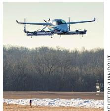
Le prototype de voiture volante de Boeing (photo) a réussi son premier essai en vol. Cet engin électrique est équipé de plusieurs hélices qui lui permettent de décoller à la verticale. A terme, il est prévu pour être autonome et capable de parcourir 80 km.
